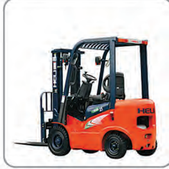
Model G Serisi CPCD 18 Motor Kubota / Dizel Kapasite 1800 Kg Kaldırma Yüksekliği 3300 / 4500 mm
