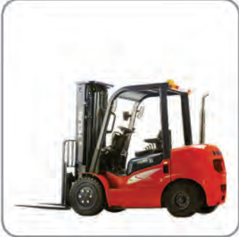
Model G Serisi CPCD 30 Motor Kubota / Dizel Kapasite 3000 Kg Kaldırma Yüksekliği 3300 / 4500 mm
