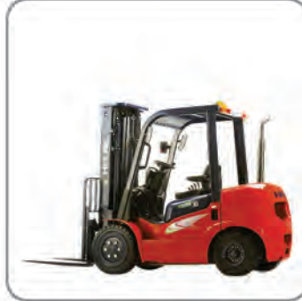
Model G Serisi CPCD 35 Motor Kubota / Dizel Kapasite 3500 Kg Kaldırma Yüksekliği 3300 / 4500 mm
