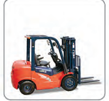
Model G Serisi CPCD 25 Motor Kubota / Dizel Kapasite 2500 Kg Kaldırma Yüksekliği 3300 / 4500 mm
