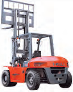
Model H-200 Serisi CPCD 90 Motor Perkins / Dizel Kapasite 9000 Kg Kaldırma Yüksekliği 3300 / 4500 mm
