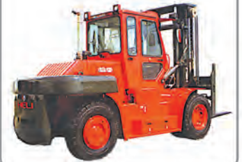
Model CPCD 140 Motor Cummins / Dizel Kapasite 14000 Kg Kaldırma Yüksekliği 3300 / 4500 mm
