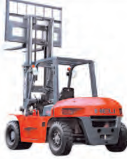
Model H-200 Serisi CPCD 100 Motor Perkins / Dizel Kapasite 10000 Kg Kaldırma Yüksekliği 3300 / 4500 mm
