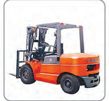
Model H-200 Serisi CPCD 40 Motor Kubota / Dizel Kapasite 4000 Kg Kaldırma Yüksekliği 3300 / 4500 mm
