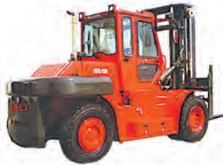
Model CPCD 135 Motor Cummins / Dizel Kapasite 13500 Kg Kaldırma Yüksekliği 3300 / 4500 mm
