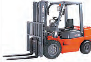
Model H-200 Serisi CPCD 30 Motor Xinchai / Dizel Kapasite 3000 Kg Kaldırma Yüksekliği 3300 / 4500 mm
