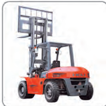
Model H-200 Serisi CPCD 70 Motor Perkins / Dizel Kapasite 7000 Kg Kaldırma Yüksekliği 3300 / 4500 mm
