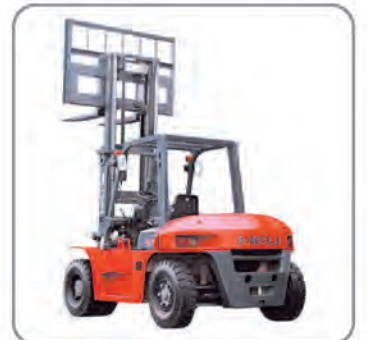
Model H-200 Serisi CPCD 80 Motor Perkins / Dizel Kapasite 8000 Kg Kaldırma Yüksekliği 3300 / 4500 mm
