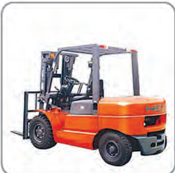
Model H-200 Serisi CPCD 50 - 500 Motor Mitsubishi / Dizel Kapasite 5000 Kg Kaldırma Yüksekliği 3300 / 4500 mm
