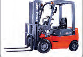
Model H-200 Serisi CPCD 15/18 Motor Xinchai / Dizel Kapasite 1800 Kg Kaldırma Yüksekliği 3300 / 4500 mm
